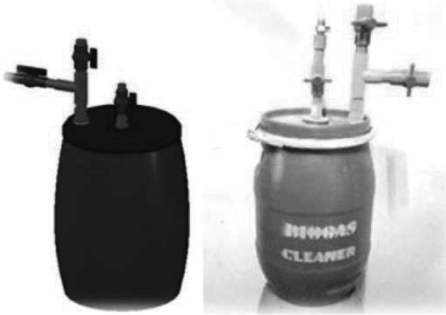
รูปที่ 1 ถังเก็บตัวดูดซับและระบบท่อ
